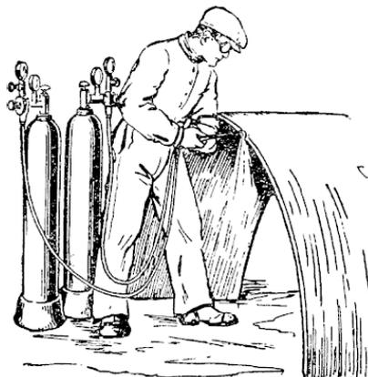
Рис. 19. Резка металла газовой сваркой (автогеном)
