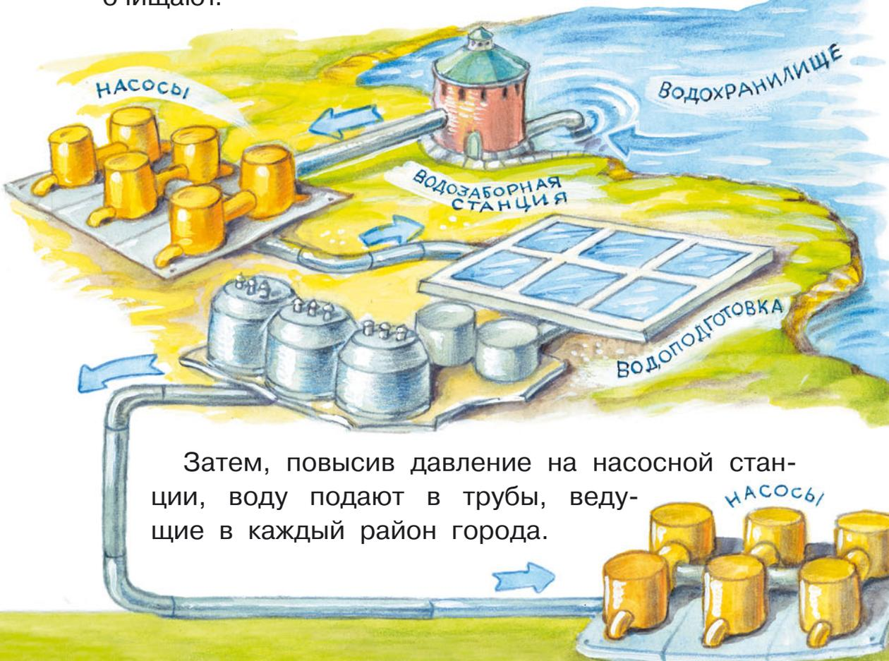
Затем, повысив давление на насосной станции, воду подают в трубы, ведущие в каждый район города.
